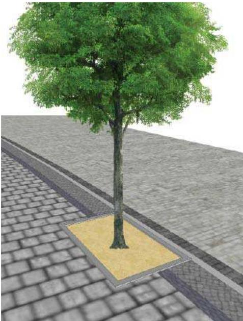
Der Granitbordstein ist hier durchgängig 30 cm breit. Nach der Sanierung soll seine Höhe maximal 8 cm
