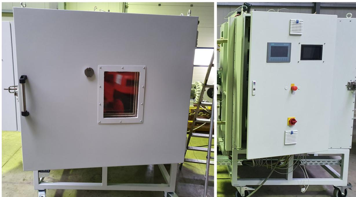
*Abbildung 3: Der Wasserstoffbackofen (links: die Backofentür und rechts: die Schaltoberfläche)*
