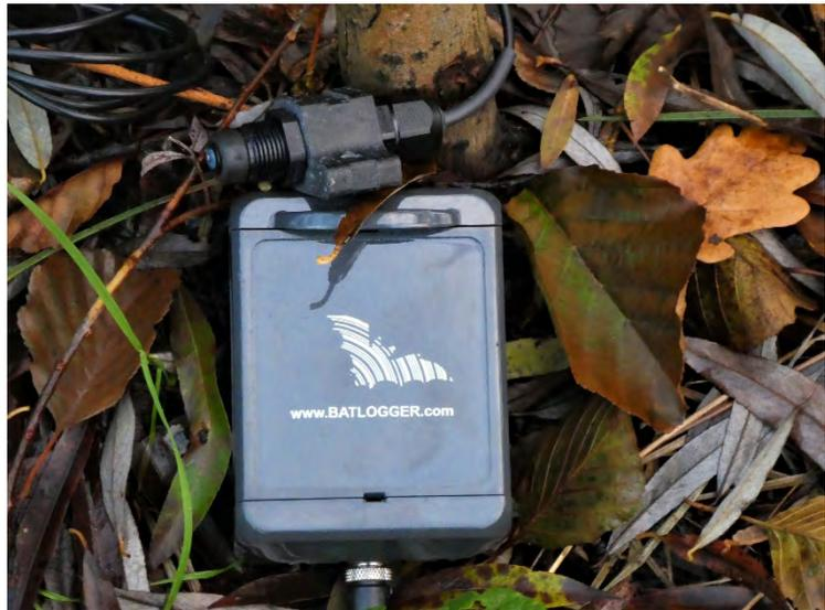
Abb. 25: Horchbox vom Typ Batlogger A.
