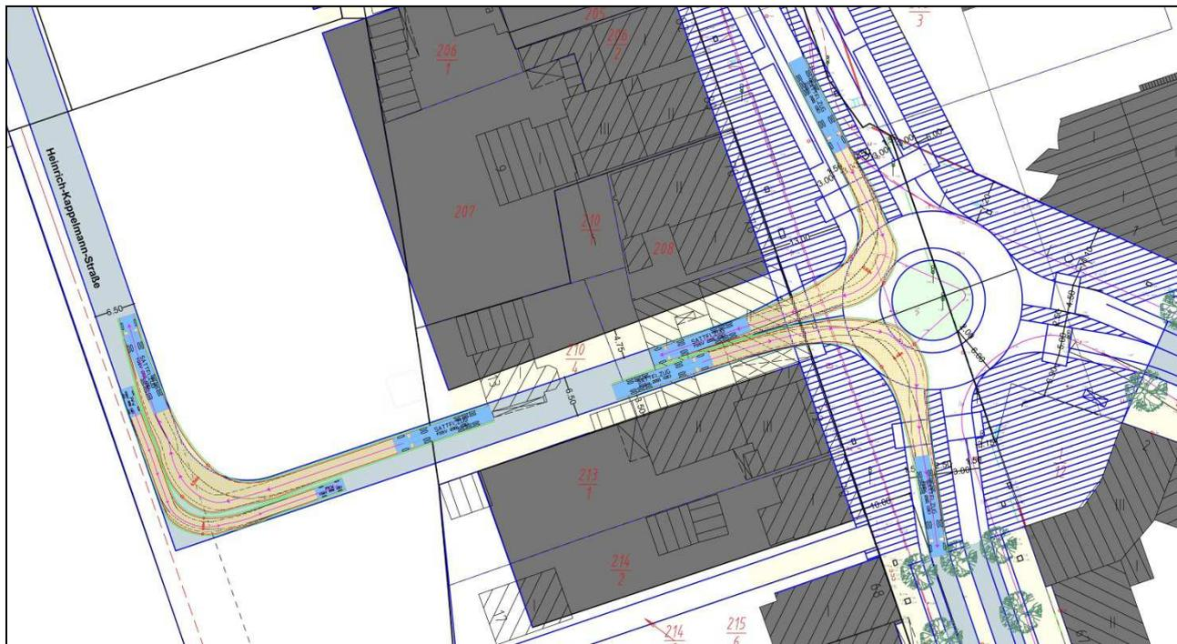
**Bild 15: Schleppkurven Sattelzug vom Kreisverkehr, in der Erschließungsschleife mit Begegnungsfall Lkw/Pkw**
