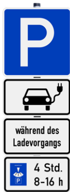
Abb. 103: Beispielhafte Positivbeschilderung von Stellplätze mit Ladestation im öffentlichen Straßenraum.
