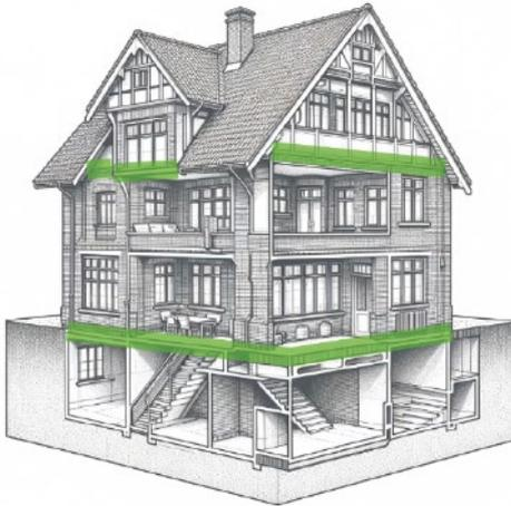
Die Dämmung der Keller- und Obergeschossdecke ermöglicht Energieeinsparungen und kann von Eigentümer:innen selbst durchgeführt werden, erfordert jedoch sorgfältige Planung aufgrund von Deckenhöhen und potenziellen Wärmebrücken.
