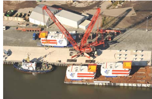
Verladung von Maschinenhäusern in Bremerhaven. Fotos: REpower Systems AG.
