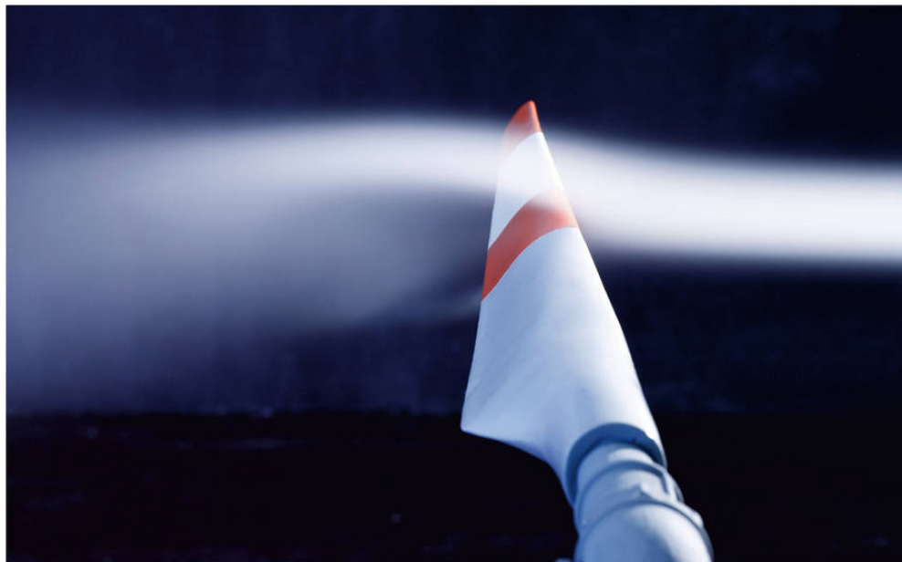
Rotorblatt im Windkanal. Foto Deutsche WindGuard GmbH
