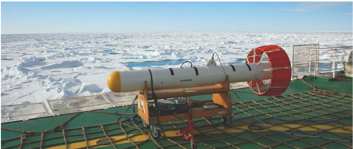
EM-Bird: Helikopter-geschleppte Sonde zur Eisdickenmessung. Foto: S. Hendricks, AWI
