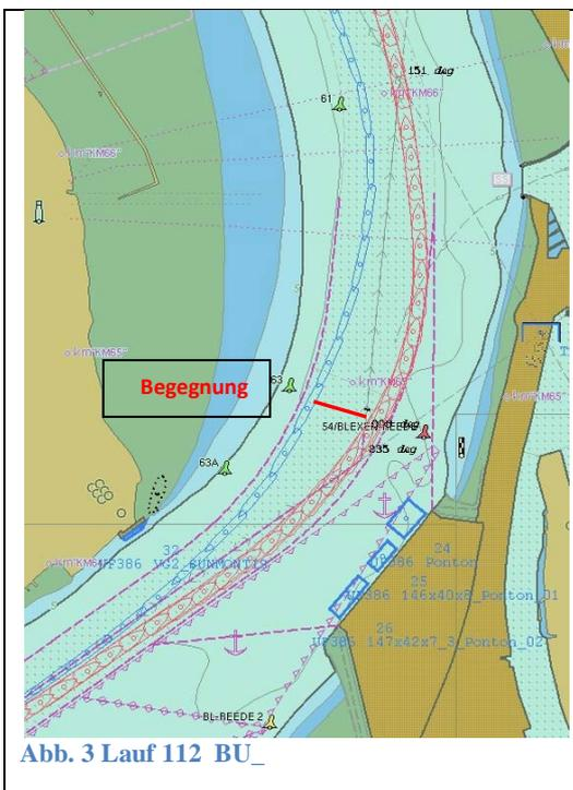
Im Verlauf des Durchfahrens des Blexer Bogens sind beide Schiffe in gewissen Bereichen dicht an den Trassenrand gekommen.
