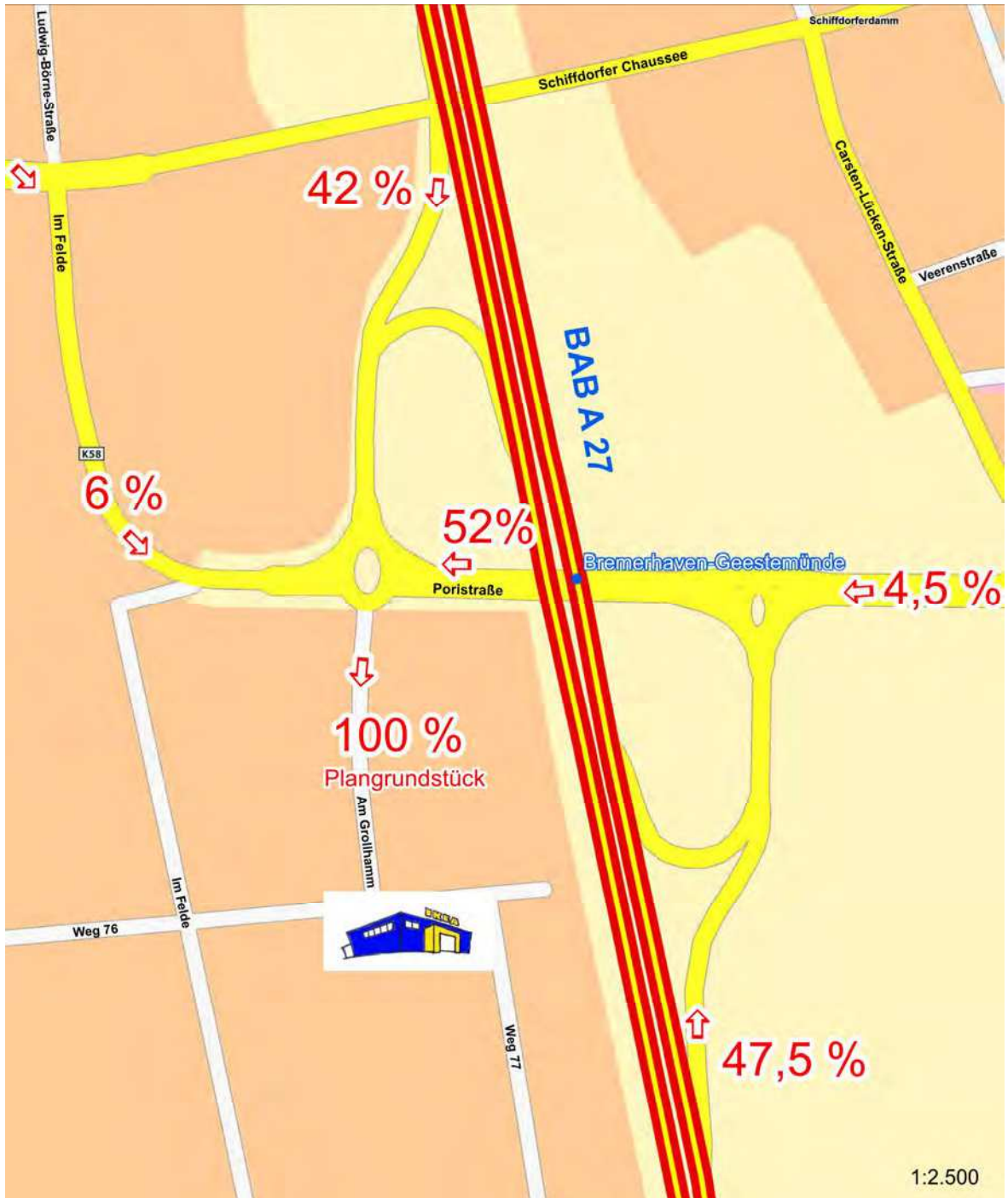
kleinräumliche Verkehrsverteilung der Prognoseverkehre (Quelle: IKEA)
